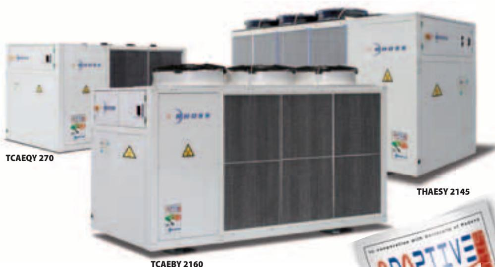
**Groupes d'eau glacée et pompes à chaleur réversibles monobloc à condensation par air et ventilateurs hélicoïdes. Série à compresseurs hermétiques type Scroll et gaz réfrigérant R410A.**
